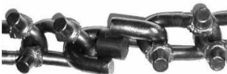
Ремонт с помощью Z-образного звена (вид снизу)
